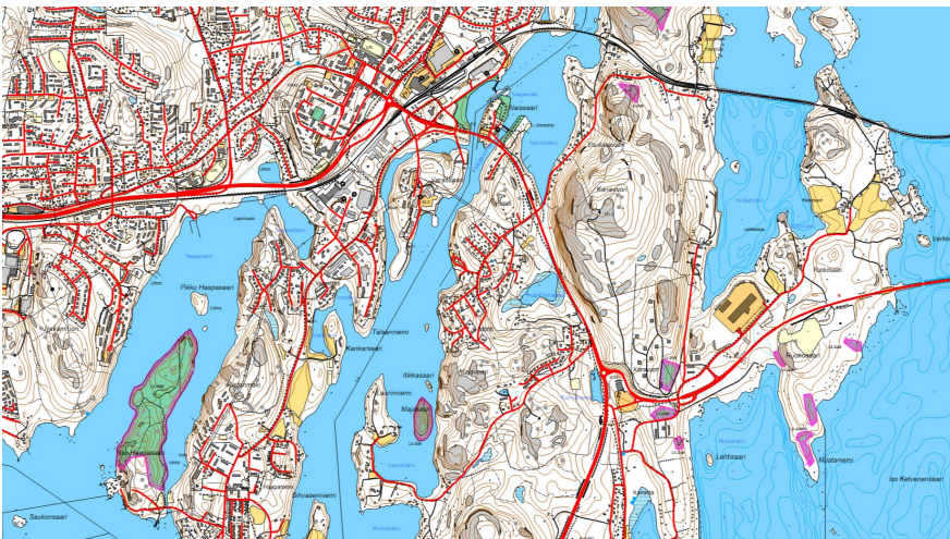
Ote maastotietokannasta vuodelta 2022. Vaajakosken moottortie, Haapalahden rampit ja uusi nelostie etelään on rakennettu, samoin 9-tie Kuopion suuntaan. Vanha nelostie on jäänyt rinnakkaistieksi. Kanavuoreen ja Vaajakosken keskustan eteläpuolelle on rakennettu kiertoliittymät eli liikenneympyrät. Ruokosaareen on rakennettu maaliikenneterminaali.
